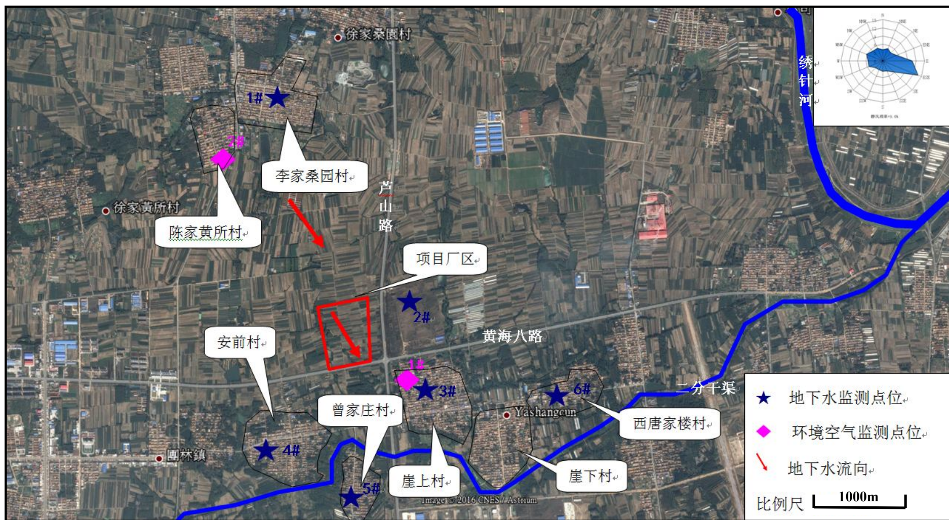
图 5.1-1 环境空气、地下水现状监测布点图
